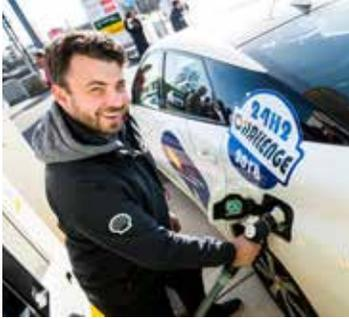
Nach dem Tanken werden die Zapfpistole und der Tankschlauch „entspannt“: Der Wasserstoff wird zurück zur Station geleitet. An der Zapfpistole bleibt nur eine sehr kleine und daher ungefährliche Menge Wasserstoff zurück – etwa ein Drittel eines Schnapsglases.
